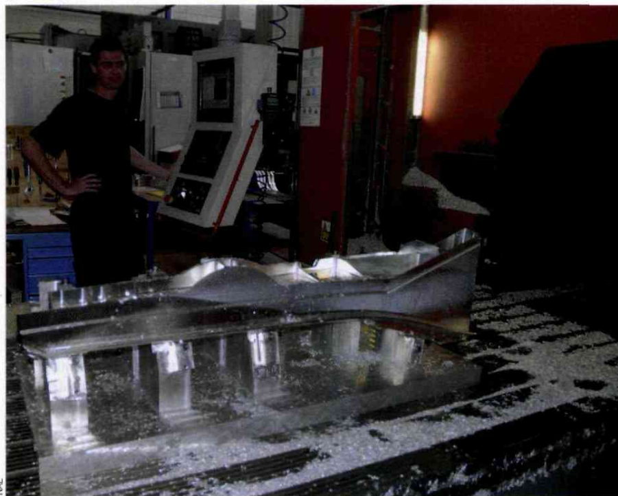
Poutre de l'inverseur Aircelle du SaM146 usinée chez Sumpar.
